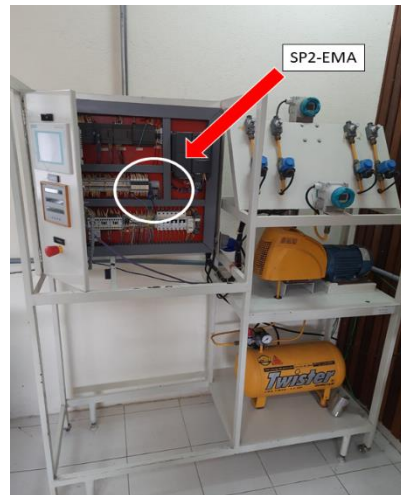
Fig. 7 Sistema de controle de compressão.
