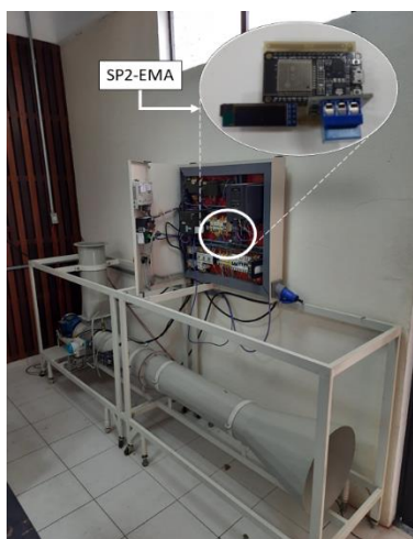
Fig. 6 Sistema de controle de exaustão.
