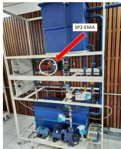
Fig. 8 Sistema de controle de nível.
