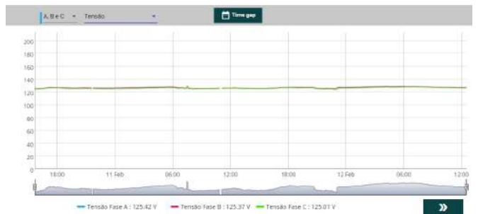
Figura 8. Variação da tensão elétrica em um dos circuitos.
