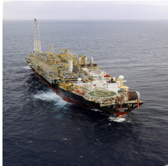
Figura 1. FPSO Cidade de São Paulo, ancorado no campo de Sapinhoá, Polo Pré-Sal da Bacia de Santos, em lâmina d'água de 2140 metros, a 310 km da costa.
