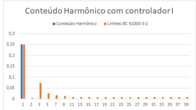
Figura 19. Norma IEC 61000-3-2 para sistema com controle integral.
