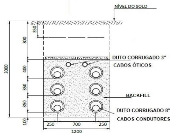
Fig. 10. Seção típica do banco de dutos
