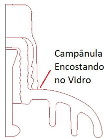
Fig. 6. Modelo do isolador de vidro com campânula encostando no vidro.
