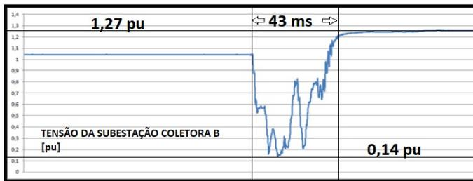
Figura 11. Tensão na barra da subestação B em pu. Fonte: O autor
