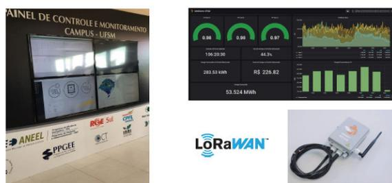
Figura 5: Central de medição e medidores de comunicação sem fio
