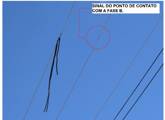
Figura 9. Evidência do curto circuito bifásico na rede do parque eólico.
