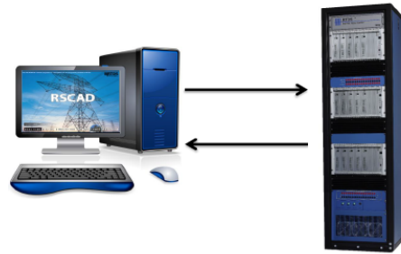
Fig. 1. Representação do software e hardware do RTDS.
