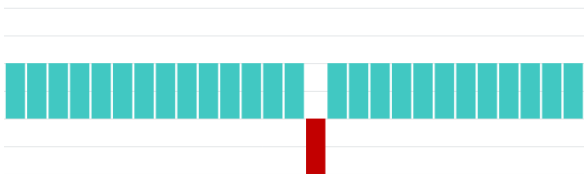
Fig. 7 Recorte de 30 minutos de um processo de DUT, em que chegaram no total 3623 mensagens e foram perdidas 100 mensagens.
