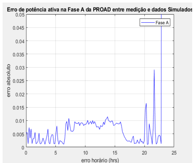
Fig. 8 - Relação do erro absoluto de potência ativa na fase A do prédio do PROAD ao longo do dia entre dados medidos pelo SISGEE e os dados do modelo no OpenDSS.
