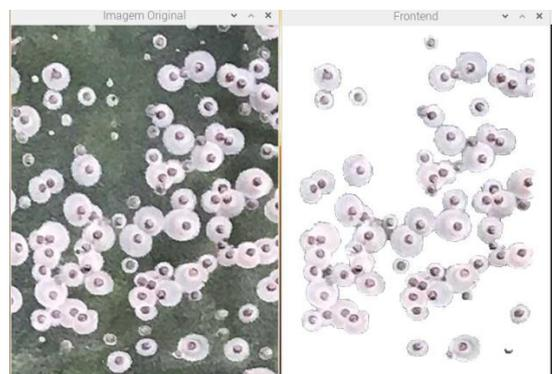
Fig. 7 Remoção de fundo na imagem exemplo da Figura 4 (dos Autores)
