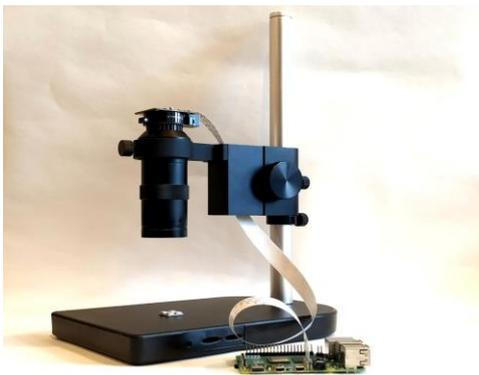
Fig. 1 Estrutura baseada em Raspberry Pi com funcionalidade de microscópio (Pimoroni Lens, Tom's hardware)
