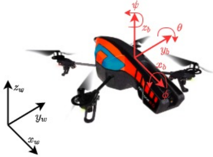
Figura 1. Quadrotor modelo Ar.Drone 2.0 e os sistemas de coordenadas adotados, sendo {w} e {b} os sistemas de coordenadas global e do veículo, respectivamente.
