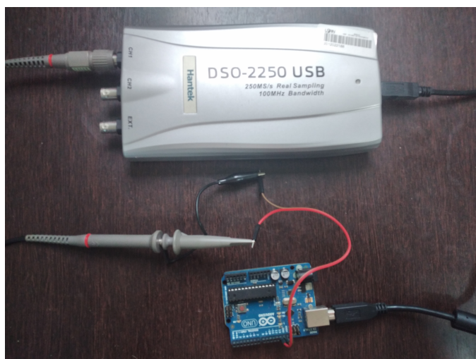
Figura 10. Estrutura utilizada para coletar a frequência de cálculo da inferência.
