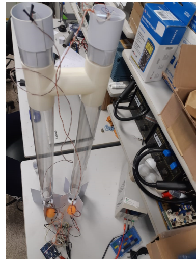
Figura 3. Sistema de levitação pneumática em fase de montagem. Fonte: Autoria própria
