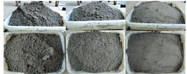
(b) Pó de brita não compactado, compactado e muito compactado.
