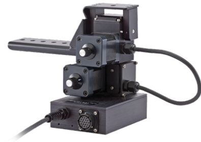
Figura 5. Vista do mecanismo de Pan-Tilt utilizado para o direcionamento das antenas.
