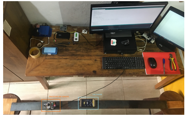
Figura 4. Setup para ensaio de vibração de uma viga biapoada.
