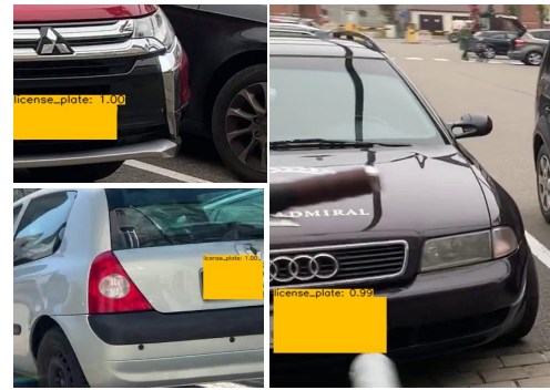
Figura 7. Detecção de placas com área visível reduzida.
