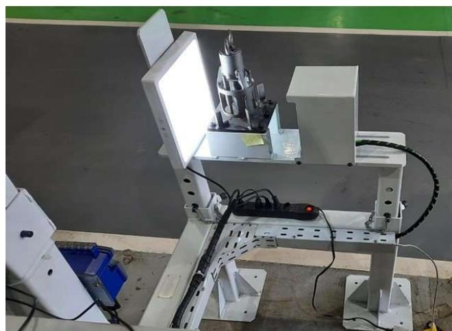
Fig. 7 Dispositivo projetado para acomodar a câmera e realizar a validação da montagem.
