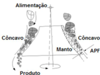
Fig 1. Princípio de um britador cônico. Fonte: Hulthén (2010).
