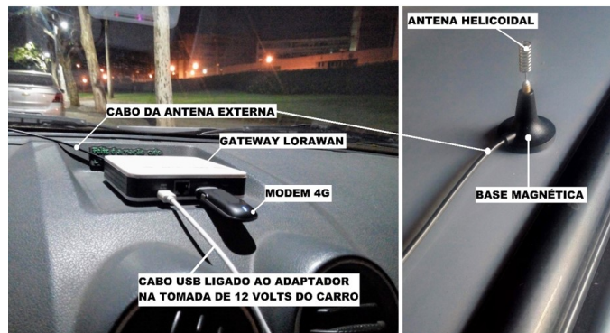
Figura 6. Instalações do gateway no carro estacionado.
