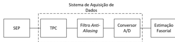
Figura 1: Diagrama de blocos simplificado do sistema de aquisição de dados.
