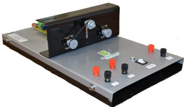
Figura 1. Módulo motor-tacogerador feito em perfil metálico. Adaptado de Serralheiro e Souza (2012).
