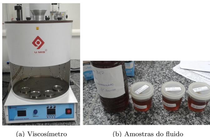
Figura 9. Teste em bancada para determinar a equação de viscosidade do óleo mineral, Lubrax Hydra XP 10, coletadas no BCS-LEA.
