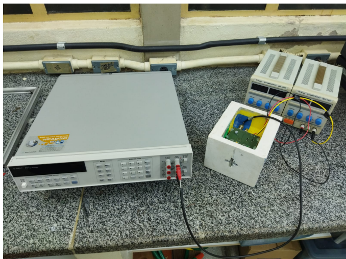
Figura 4. Montagem experimental. À esquerda o multímetro Agilent Technologies , modelo 3458A. À direita, a fonte de alimentação simétrica. Ao centro, a placa contendo o sensor SIRRS01-3 montada em um suporte de alinhamento para realizar as medições.
