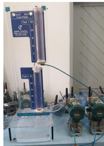
Figura 1. Equipamento utilizado: o sistemas de tanques e os sensores de nível sem fio.
