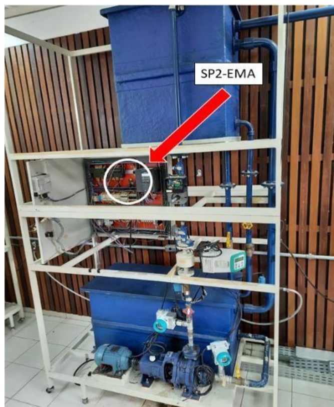
Fig. 7 Sistema de controle de nível.
