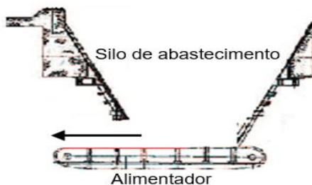
Figura 6. Silo de abastecimento.
