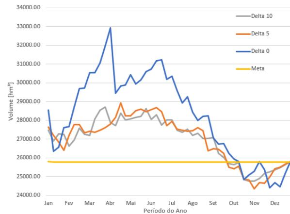
Figura 3. Valores de volume total das usinas hidrelétricas para diferentes valores de  $\Delta_k$ .
