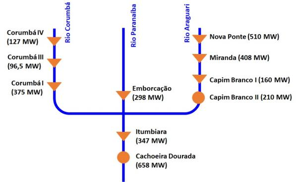
Figura 1. Cascata hidráulica dos rios Araguari, Corumbá e Paranaíba do sistema elétrico brasileiro.
