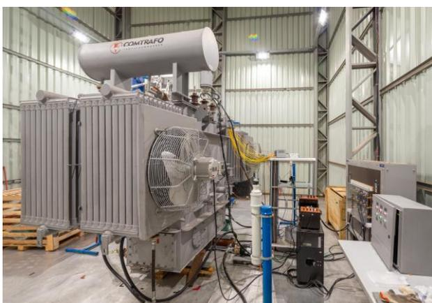
Fig. 2 Transformador protótipo e setup de ensaios.
