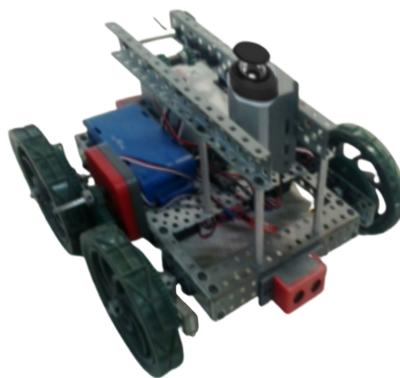
Figura 2. Robô equipado com câmera omnidirecional.
