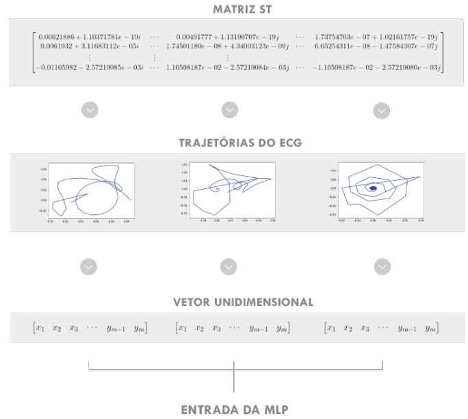
Figura 3. Diagrama do processo de aquisição das trajetórias do ECG
