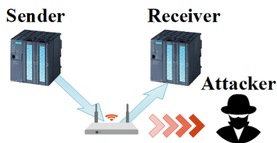
Figura 1. Ataque de espionagem no canal de comunicação entre emissor e receptor.
