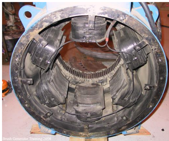
Fig. 3. Exemplo de enrolamento de campo da excitatriz (Manual da Brush).
