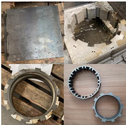
Figura 5. Fabricação do estator da máquina utilizando o método de eletroerosão.
