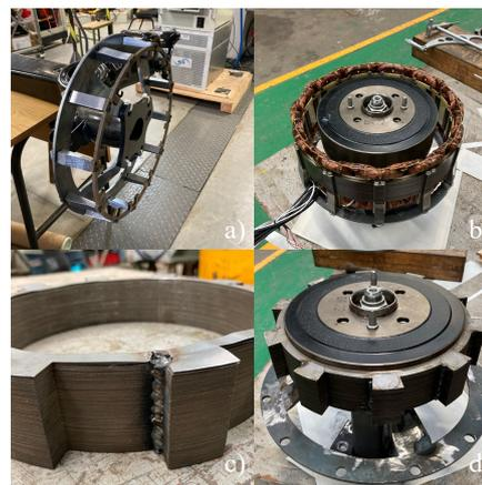
Figura 6. Fabricação do rotor: a) Estrutura de fixação do estator; b) Ajuste da concentricidade do rotor; c) Cordão de solda no núcleo do rotor; d) Fixação do rotor pelo método de aquecimento/contração.
