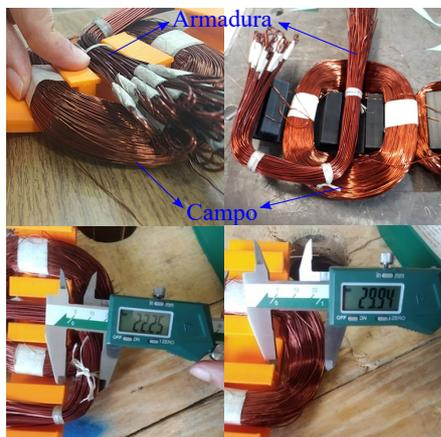
Figura 3. Avaliação das cabeças de bobina utilizando protótipos em impressão 3D.
