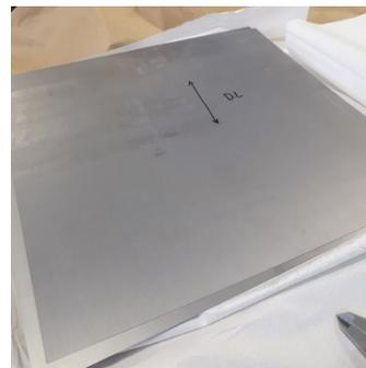
Figura 4. Aço elétrico utilizado na fabricação do protótipo.
