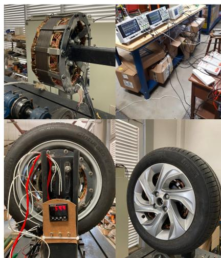
Figura 8. Bancada de testes desenvolvida para validação experimental.
