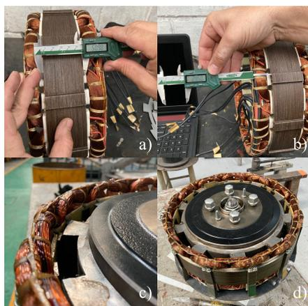
Figura 7. Fabricação do estator: a) Medição do pacote de chapas do estator;b) Conferência dos limites dimensionais das cabeças de bobina;c) Detalhe do verniz isolante aplicado nas bobinas do estator;d) Protótipo finalizado.
