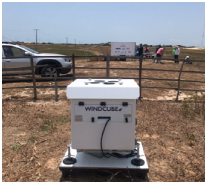
Figura 3. Lidar instalado em campo.
