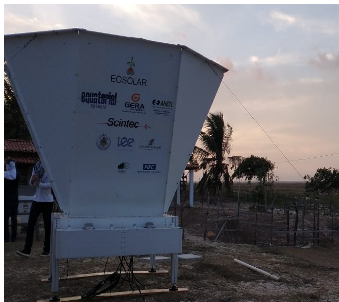
Figura 2. Perfilador Sodar instalado em campo.
