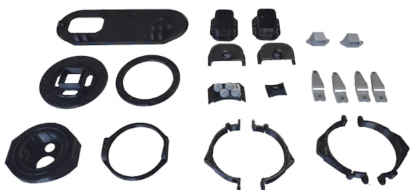
Figura 7. Componentes impressos em 3D da estrutura mecânica do robô.
