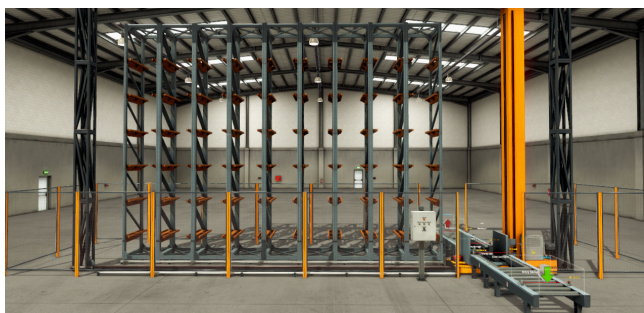
Figura 8. Visão do sistema de estoque com o robô empilhadeira.
