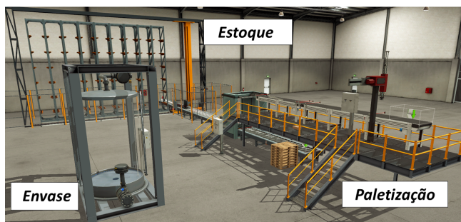
Figura 2. Ilustração de cada uma das etapas do processo da fábrica virtual.
