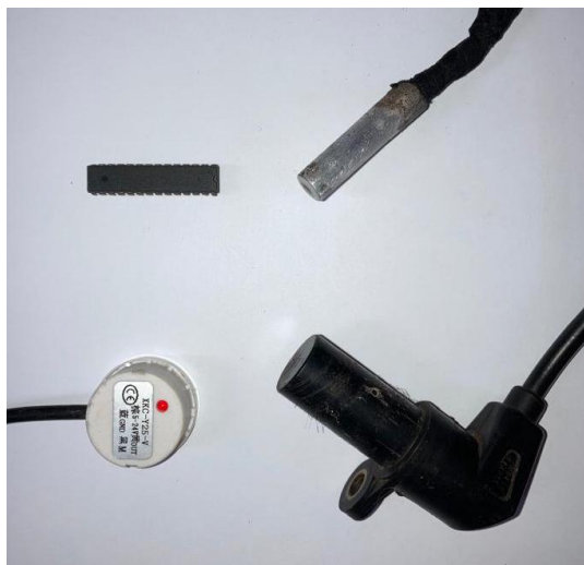
Figura 3. Dispositivos do terminal emissor: ATmega328P, LM35 encapsulado, XKC-Y25-V e sensor indutivo automotivo.
