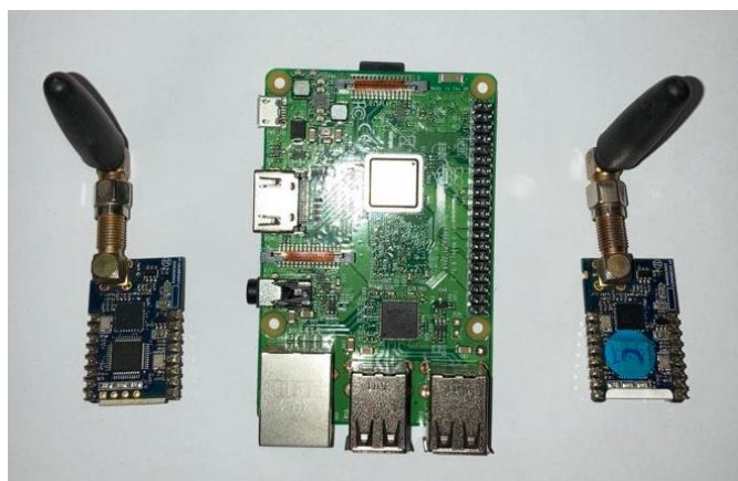
Figura 5. Dispositivos do terminal receptor: Raspberry Pi 3 e Módulos LoRaMesh com antenas específicas para testes em bancada.
