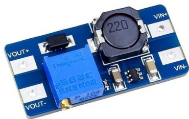
Figura 7. Conversor utilizado para regulagem de tensão. Fonte: (Usinainfo, 2022).
