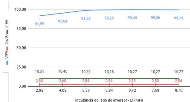
Figura 5. Influência da variação de  $L_f$  na tensão  $V_f$  [V] e nas correntes  $I_{inv}$  e  $I_f$  [A].
