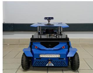
Figura 1. Robô móvel com a câmera acoplada.
