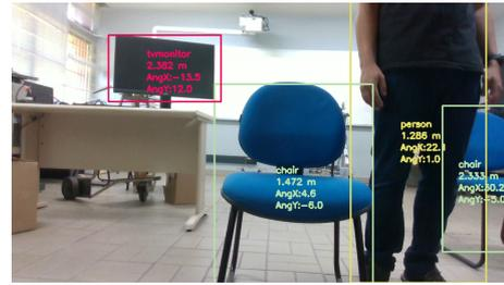
Figura 3. Detecção de objetos realizados pelo YOLO.
