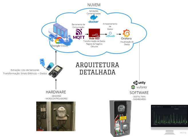
Fig. 3 Arquitetura resumida em 3 camadas proposta para a solução de Gêmeo Digital de um medidor de energia baseado em IoT.
