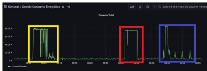
Fig. 7 Padrões de comportamento de banho sugeridos, no dia 18/04/2022. O padrão 1 está destacado em vermelho, o padrão 2 está destacado em amarelo e o padrão 3 está destacado em azul
