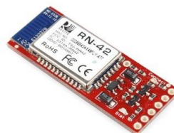
Figura 9. Módulo Bluetooth usado para transmitir dados de torque da placa Arduino para um smartphone Android dentro de um alcance de até 36 m.
