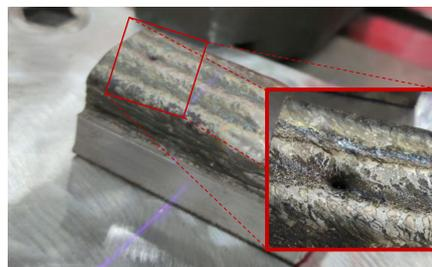
Figura 1. Cordões produzidos por um processo WAAM e um defeito destacado na camada.
