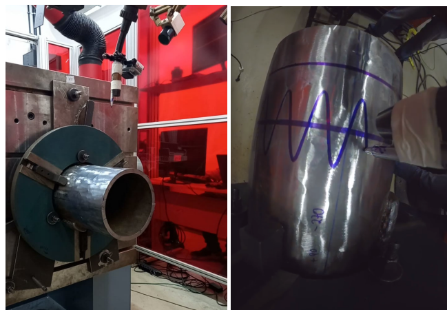
Figura 6. Configuração experimental: cilindro acoplado à mesa posicionadora e a caneta acoplada à ponta da tocha.
