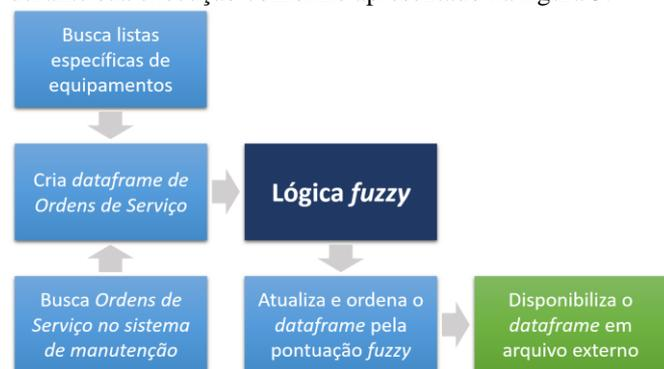
Figura 5: Fluxo de funcionamento da ferramenta de priorização com base em técnicas de RPA para desenvolvimento do algoritmo (autoria própria).
