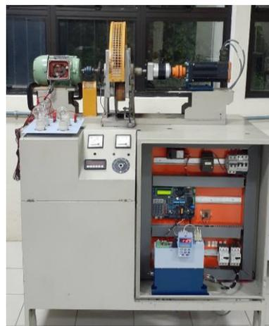
Fig. 1 Bancada Hidrocinética: Protótipo desenvolvido
